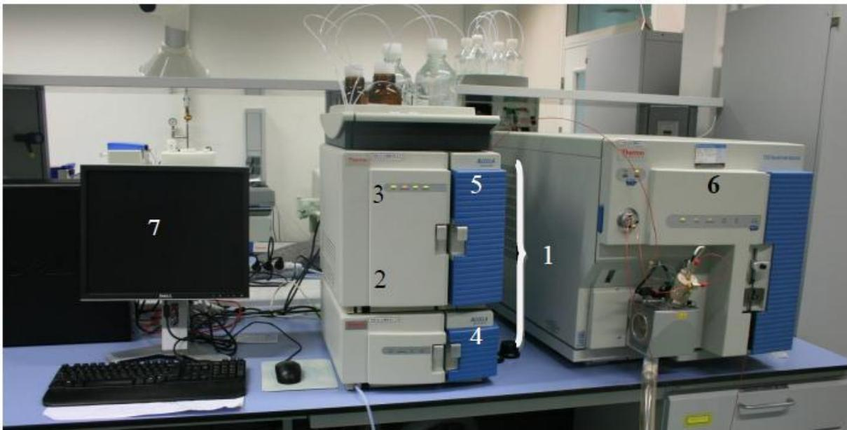
Figure 2- 1 Appareillage de la chromatographie en phase liquide couplée à la spectrométrie de masse en tandem
