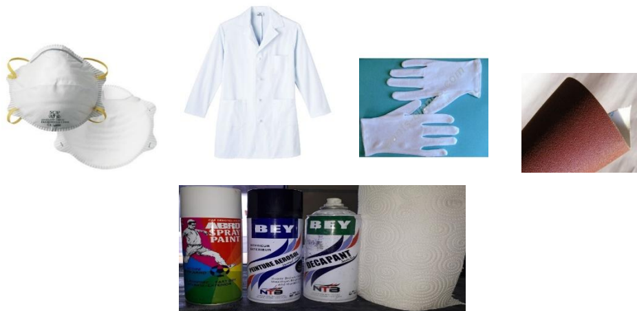
Figure 5-3: Outils nécessaires pour la réalisation du mouchetis.
