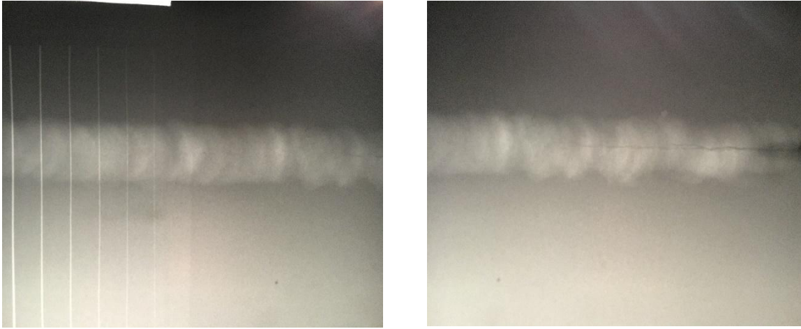
Figure 1-8: Radiographie de la plaque soudée TIG pulsé à deux passes
