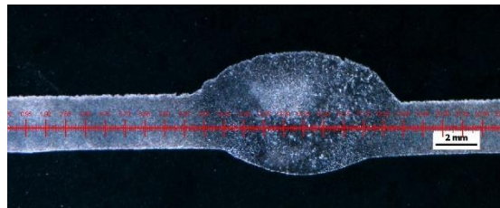
Figure 1-13: macrographie de la soudure 3 osités
