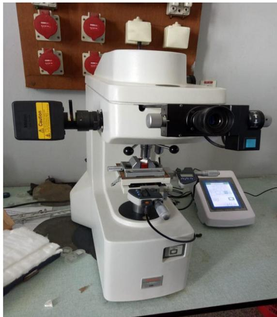
**Figure IV.8 :** le micro-duromètre utilisé pour nos essais.
