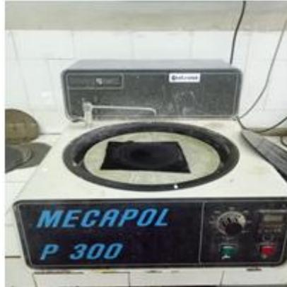
**Figure IV.5** : Polisseuse de finition MECAPOL P300,
