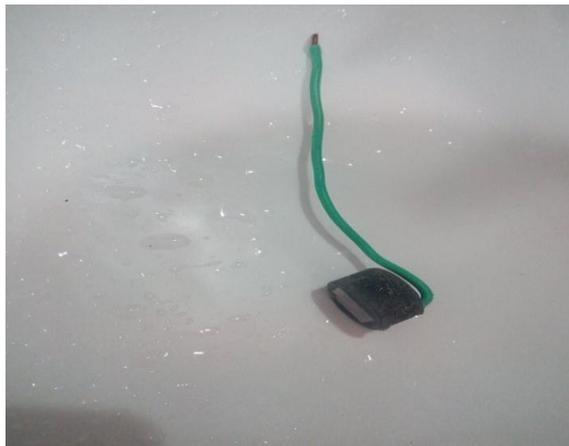
**Figure IV.12** : Modèle d'échantillon pour les analyses électrochimiques
