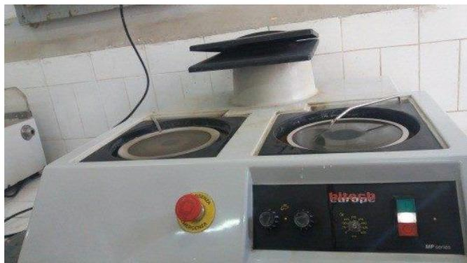
**Figure IV.4** : Polisseuse mécanique de type hitech europe,
