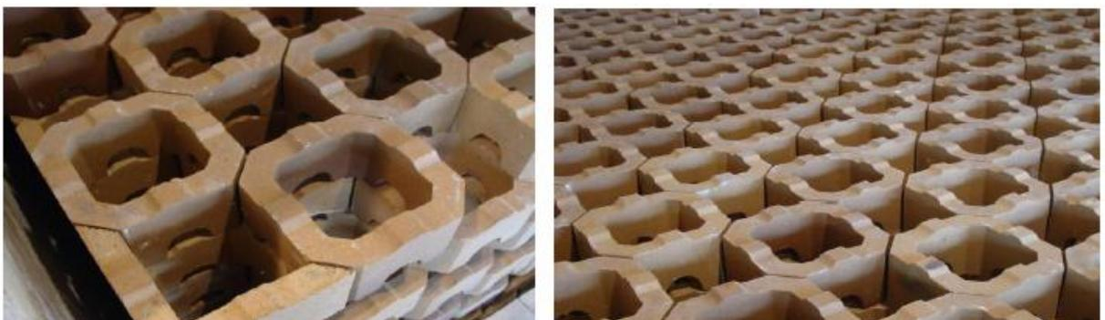
*Figure III. 7: Photo des briques d'empilage du four MFG.*
