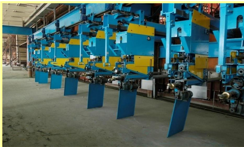
Figure III. 13: Photo d'une série du Top Rolls (vue d'extérieur).
