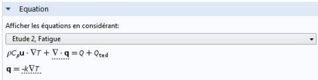
**Figure IV.8** : capture d'écran des équations utilisées pour le calcul du transfert thermique de conduction.
