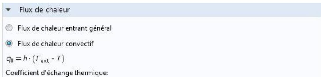
**Figure IV.9** : capture d'écran de l'équation utilisée pour le calcul du transfert thermique de convection
