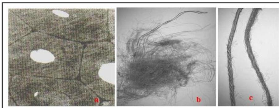
**Figure 2.10 :** Portion d'une section verticale de fibre de jute (**a**), amas de fibre (**b**), et brins tressé et filé (**c**) [10]
