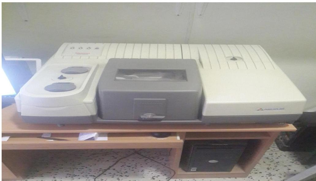
*Figure II- 6 : Appareil utilisé pour les spectroscopies FT-IR*
