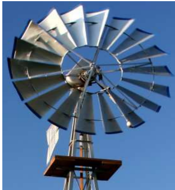
Figure 1.1 : Eolienne de pompage d'eau.
