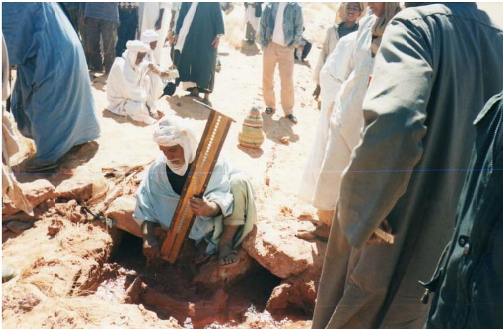
**Fig.4.5.** Opération de mesure à l'aide d'une Chekfa rectangulaire à Ain zeglouf près de Reggane (Benziada.s,1996)
