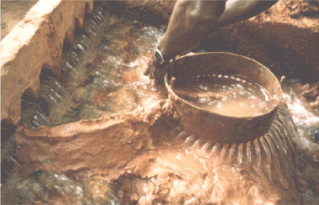
**Fig.4.4.** Opération de mesure à l'aide d'une Chekfa circulaire à Aoulef dans la région du Tidikelt (Benziada.s,1996)
