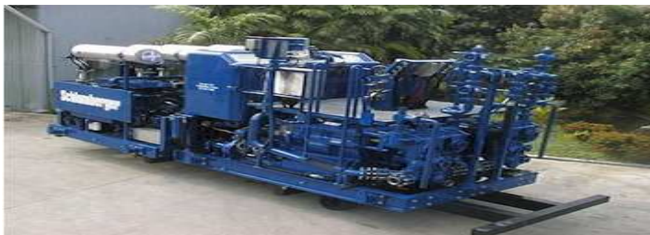
Figure III.7: Unité de cimentation pour forage en mer [1].
