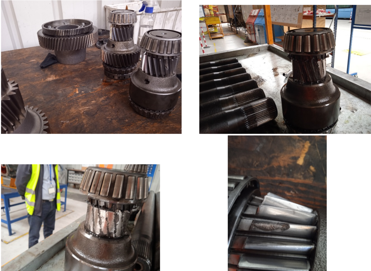
FIGURE 20 – Cas de défaillance des engrenages (6DR) mécaniques du pont
