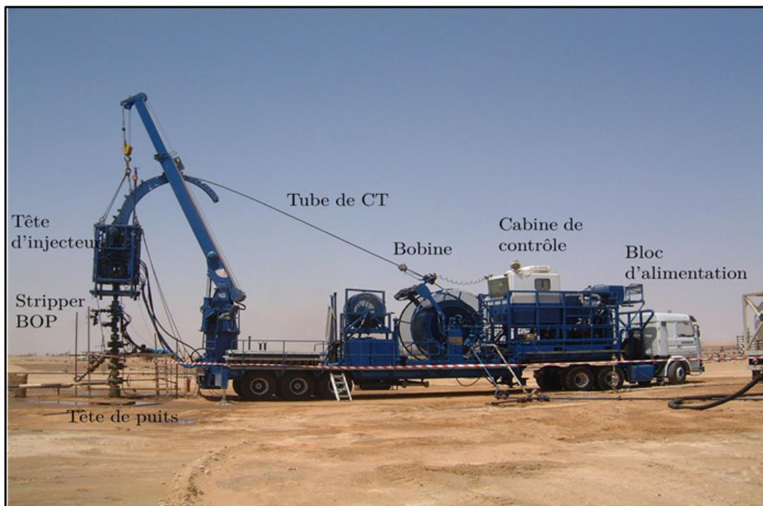
Figure 3.1. Présentation d'une unité de Coiled Tubing et ses composantes
