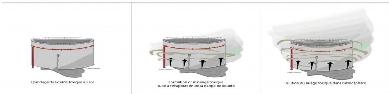
**Figure 1.6 Différentes phases de développement de l'émission et la dispersion des produits chimique [10]**
