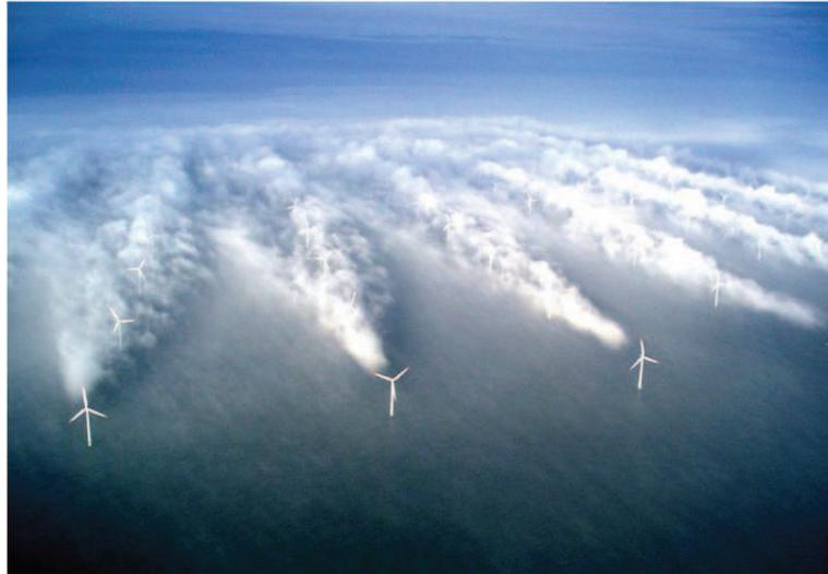
FIGURE 1.10 – Sillage d'un parc éolien offshore [5].
