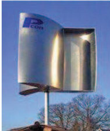
FIGURE 1.3 – Éolienne savonius
