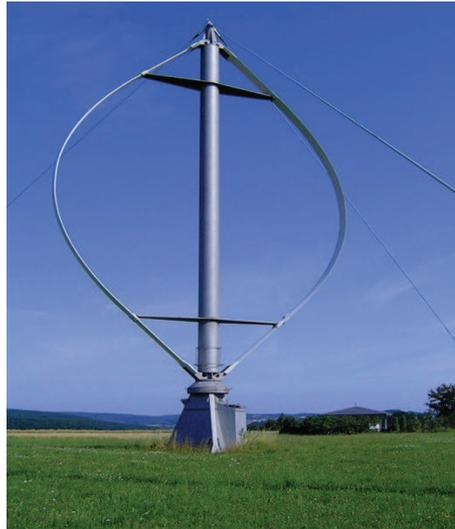
FIGURE 1.4 – Éolienne Darrieus à pales paraboliques
