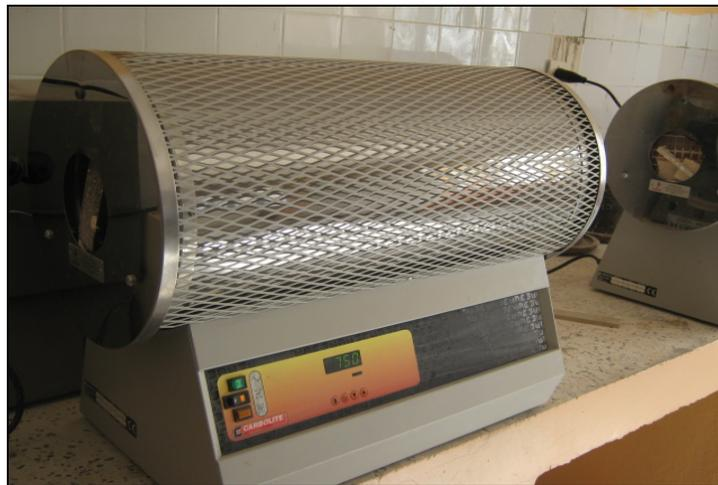
*Figure II.03 : Four électrique a canal horizontal pour traitements thermiques.*
