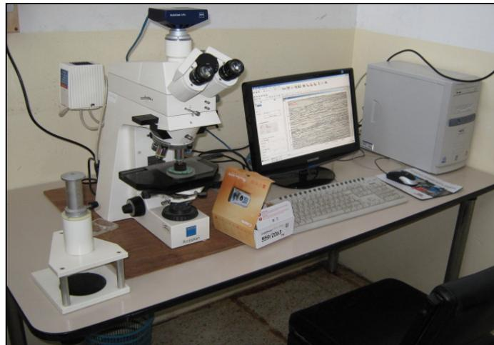
*Figure II.05: Microscope optique utilisés pour la micrographie.*
