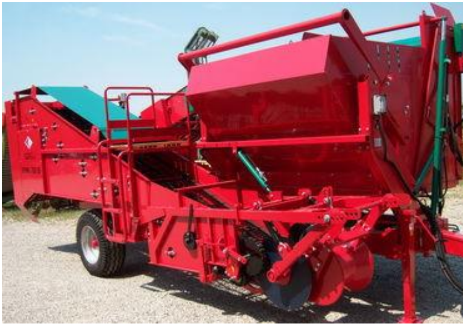
Fig. 1.9 – Arracheuse ramasseuse de pomme de terre de type SPRING ALX-RH [Int11]
