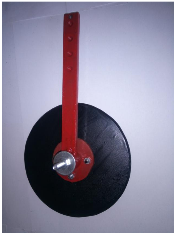
Fig. 3.7 – La réalisation du disque avec son support pour le prototype
