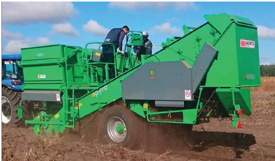
Fig. 1.7 – Arracheuse ramasseuse de pomme de terre de type UNIA [Int9]
