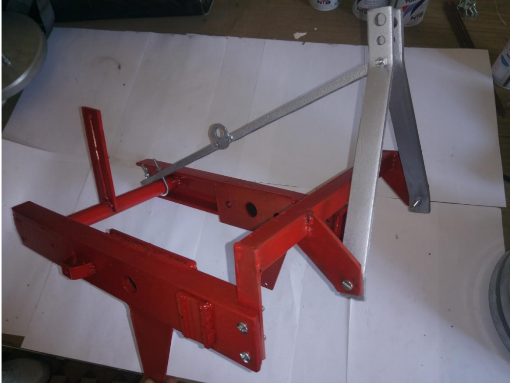
Fig. 3.3 – La réalisation du châssis pour le prototype
