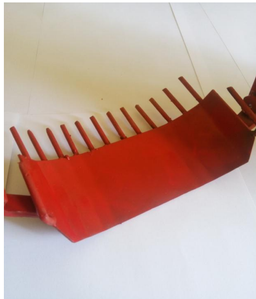
Fig. 3.5 – La réalisation du soc pour le prototype
