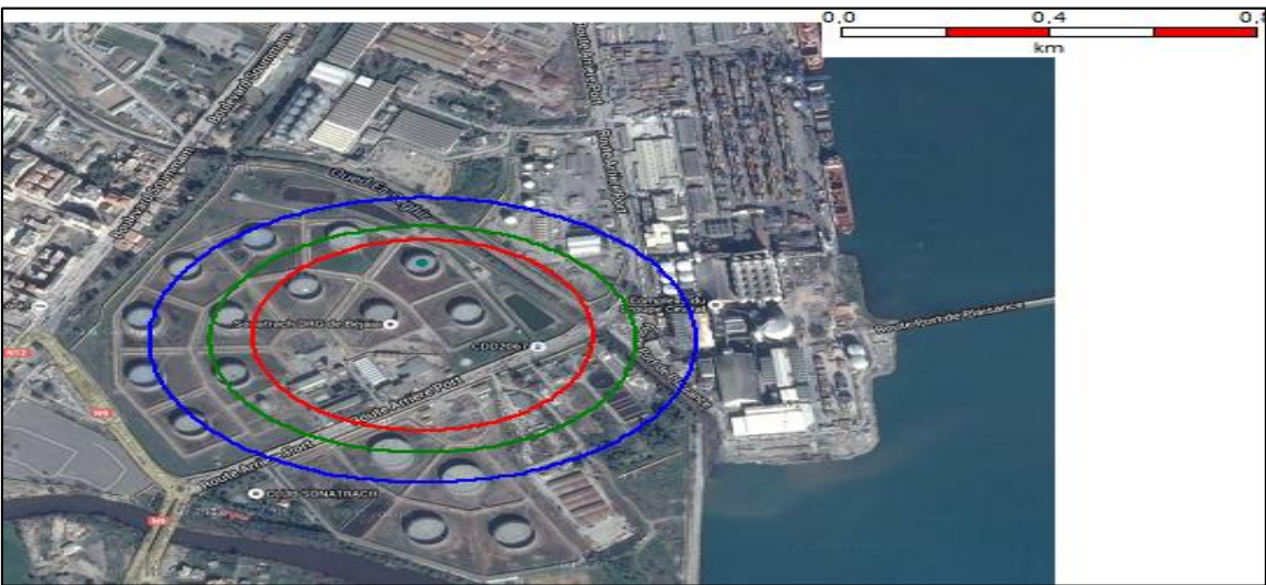
Figure 31 : Résultat d'un feu de toit du bac AB12 du terminal nord avec la classe 3F
