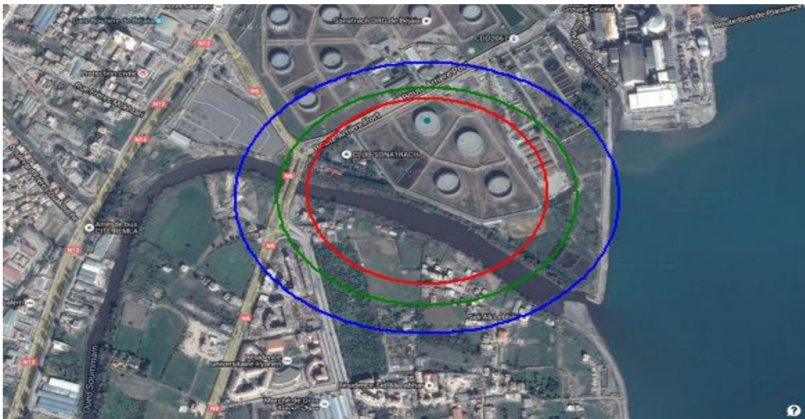
Figure 33 : Résultat d'un feu de toit du bac R13 du terminal sud avec la classe 3F
