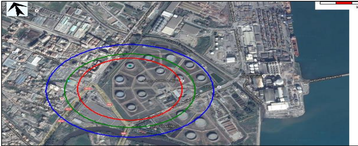
Figure 32 : Résultat d'un feu de toit du bac AC9 du terminal nord avec la classe 5D
