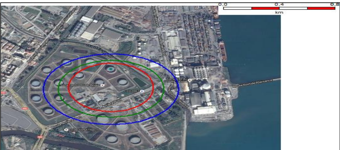
Figure 29 : Résultat d'un feu de toit du bac AB12 du terminal nord avec la classe 5D.
