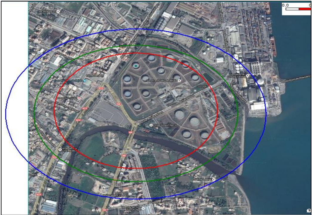
Figure 36 : Résultat d'un feu de bac AC9 de terminal nord avec une classe 5D.
