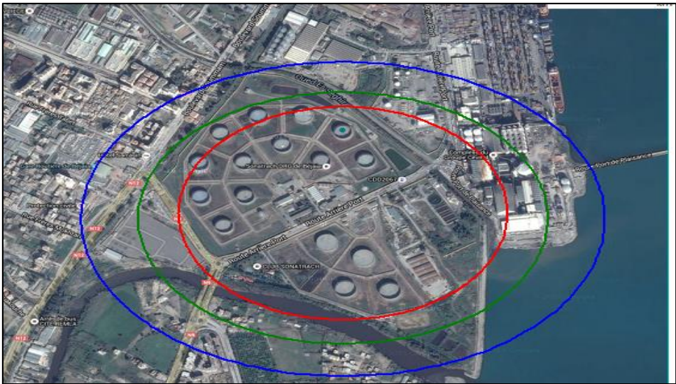
Figure 35 : Résultat d'un feu de bac AB12 de terminal nord avec une classe 5D
