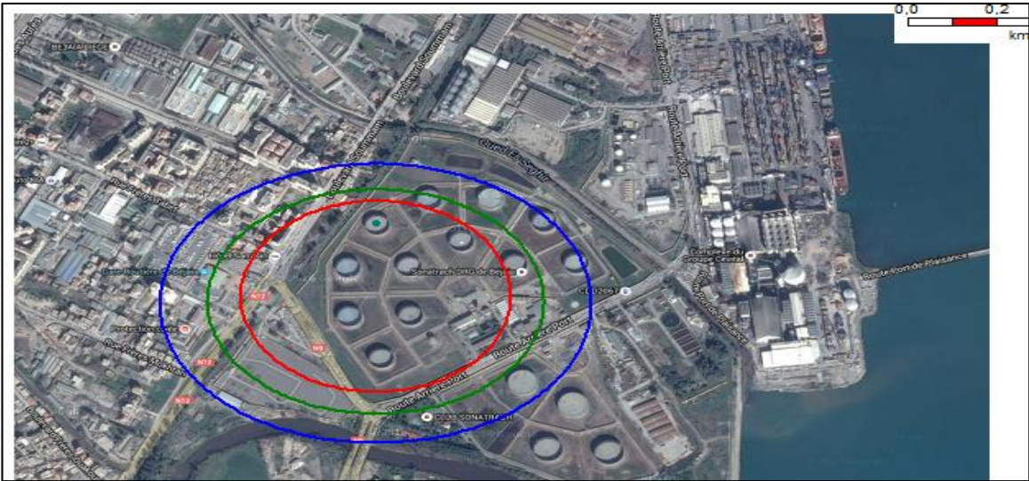
Figure 30 : Résultat d'un feu de toit du bac AC9 du terminal nord avec la classe 3F.
