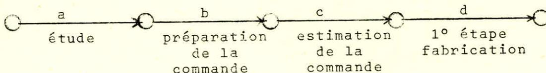
Les opérations a, b et d auront des durées calculées (en fonction des moyens utilisés) tandis que l'opération c aura une durée imposée : le délai donné par le fournisseur et accepté par le fabricant.
