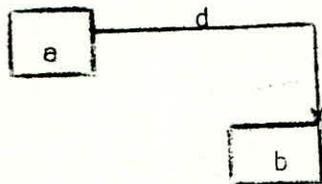
L'opération a doit se terminer d'unité de temps avant la fin de b. Si  $d = 0$ , a et b doivent se terminer en même temps.
