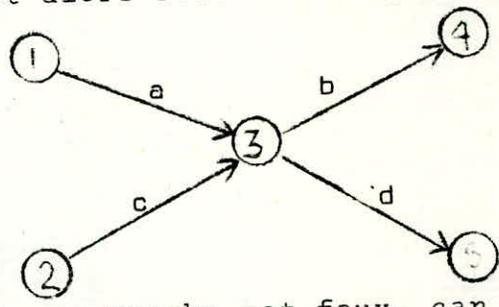
D'une part, ce graphe est faux, car il signifie que b (réparer la crevaison) doit suivre c (sortir la roue de secours), ce qui n'est pas nécessaire.
