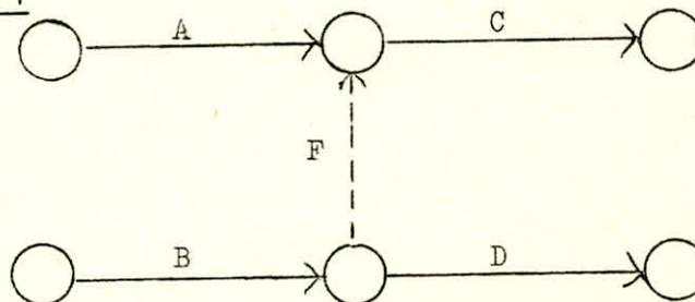
Sur cette figure, si nous voulons exprimer, par exemple, que les tâches B et C utilisent un même moyen unitaire : grue, tour, ouvrier spécialisé ... La seule question à résoudre porte sur l'ordre dans lequel il convient de lancer les diverses tâches à placer en disjonction.
