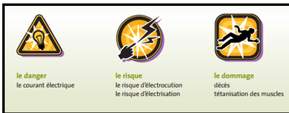
Figure 4 : exemple de définition pour l'électricité.
