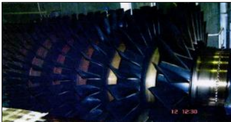
Figure 12: Les étages du compresseur.
