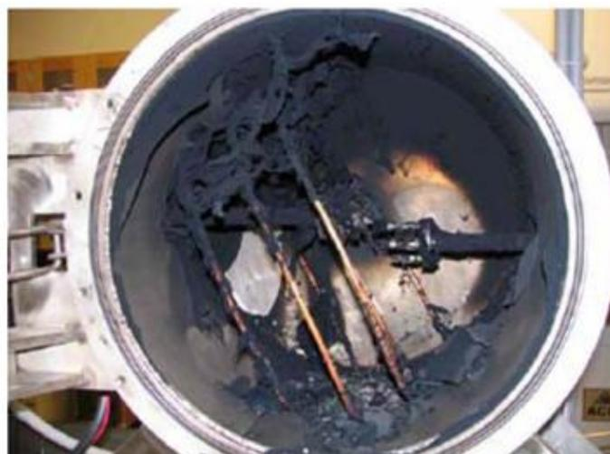
Figure 2.18 Système de décharge à l'arc de laboratoire pour la production de nanotubes de carbone à paroi unique (SWCNT)
