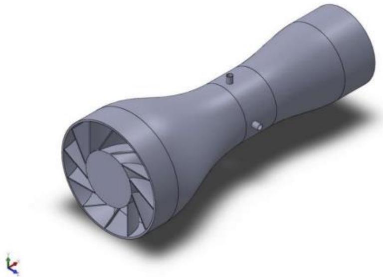
**Figure 1.5** Modèle d'un mélangeur venturi avec ventilateur [12]
