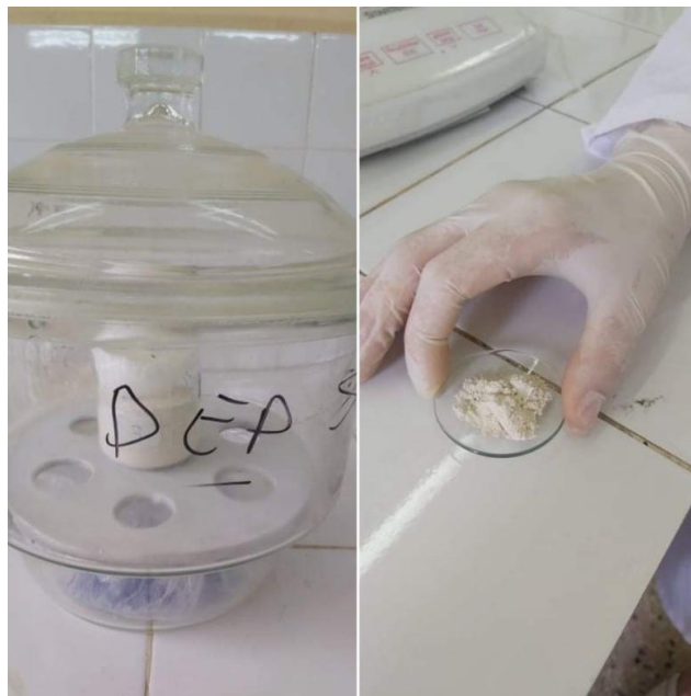
Figure 3.3 : L'argile utilisée : Bentonite provenant du gisement Roussel (Maghnia)
