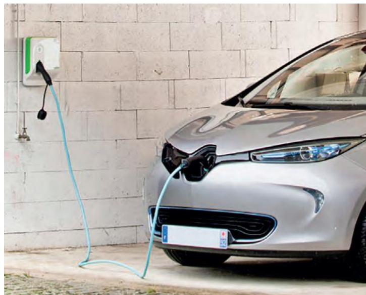
Figure V-5: Prise de recharge d'un particulier (56)
