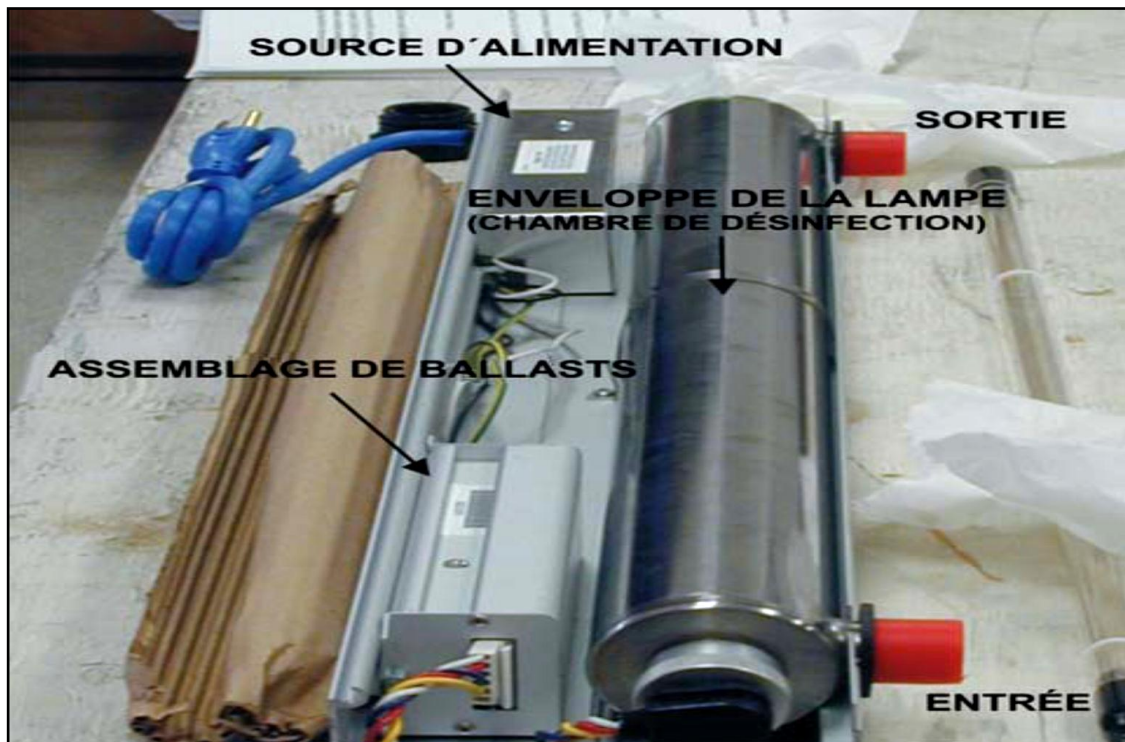
Figure I-12: Schéma de l'appareil de traitement UV avec le couvercle enlevé [BOU06], [HAR08].
