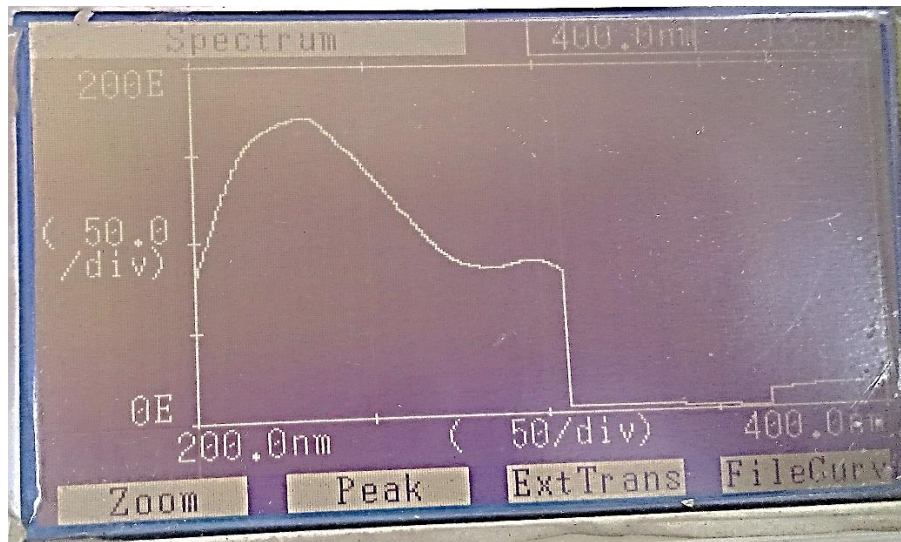
Figure IV.2 : Balayage spectroscopique du paracétamol à 10 mg/L
