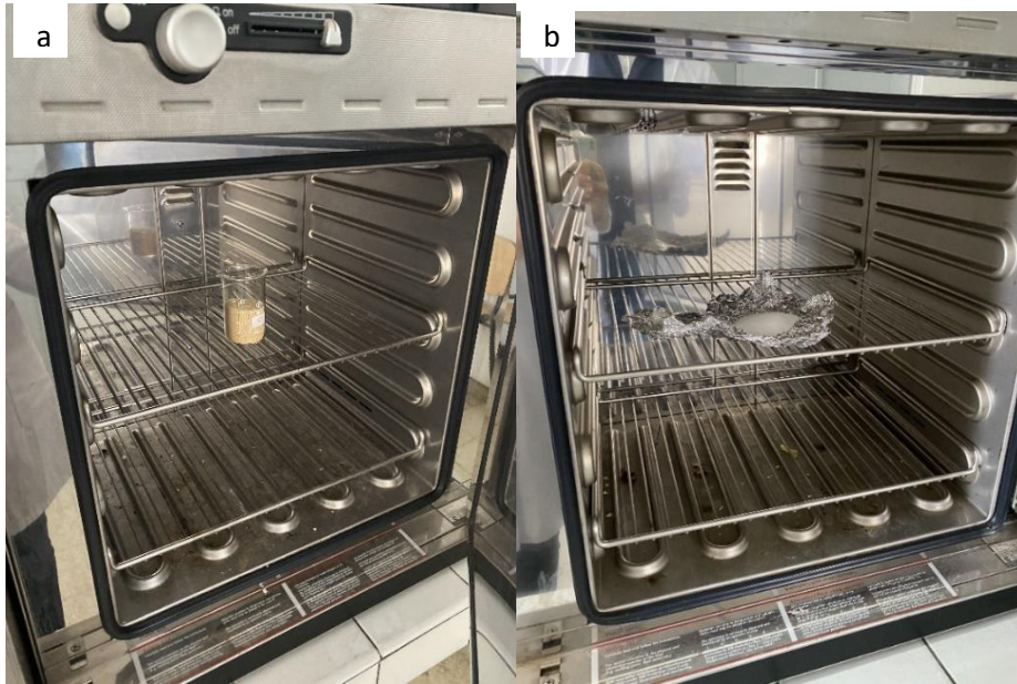
Figure 2.4 : Etuvage de la fibre Atriplex halimus (a) et du PVC (b).
