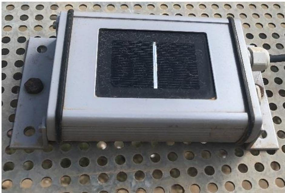
**Figure 42: cellule solaire non nettoyée**
