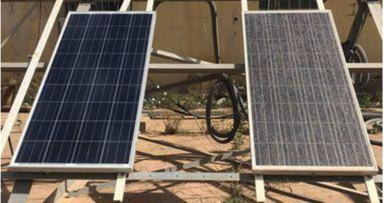
**Figure 23:les deux modules PV nettoyé(A) et non nettoyé (B)**
