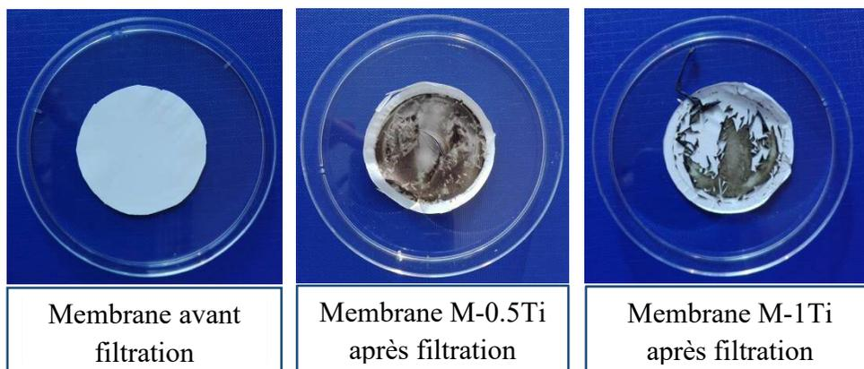
**Figure III.36.** Etat des membranes avant et après utilisation pour la filtration des rejets réels
