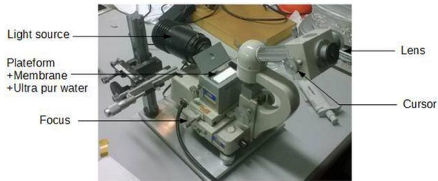
**Figure II.14.** Tensiomètre optique pour la mesure de l'angle de contact
