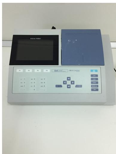
Figure 11 : spectrophotomètre à uv visibles
