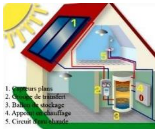
Figure 1. 3 Énergie solaire thermique.
