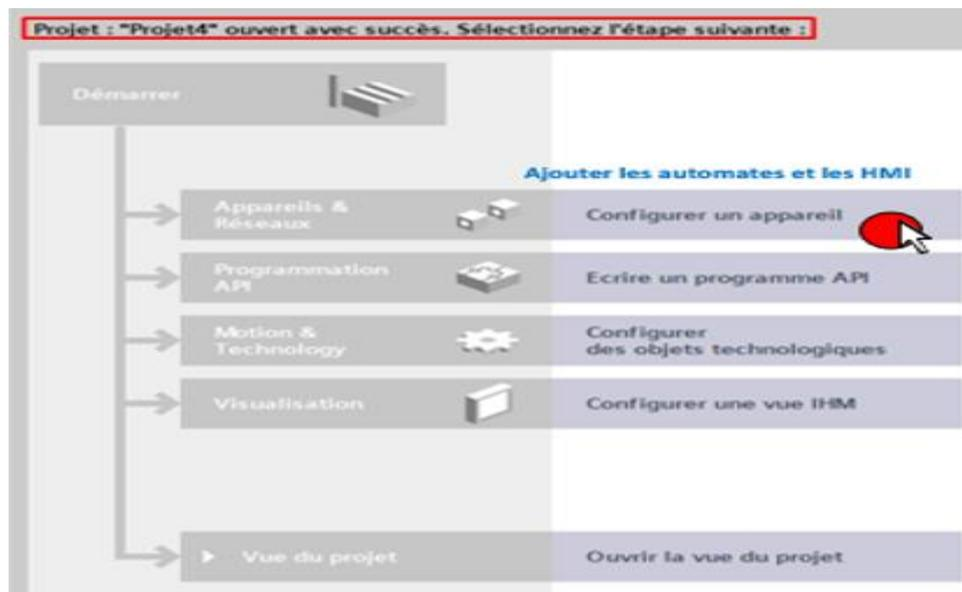
**Figure IV.3: Configurer un appareil dans TIA Portal**
