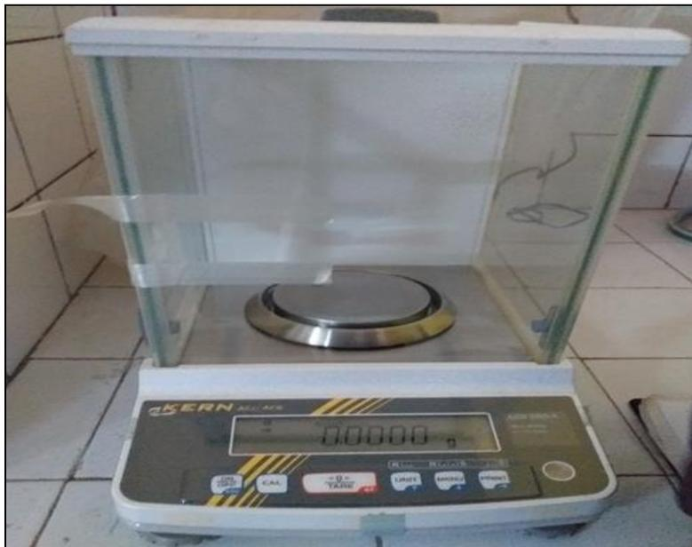
Fig.4.7. Balance électronique de type KERNACJ/ACS AC6 2204
