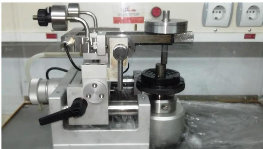
Fig.4.9. Tribomètre (csm+instruments TRIBOMETER)
