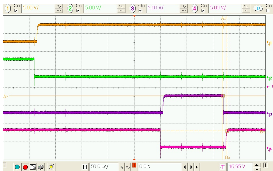
FIGURE II.22: Exemple de temps mort pour deux signaux de commande de deux interrupteurs appartenant au même bras de l'onduleur
