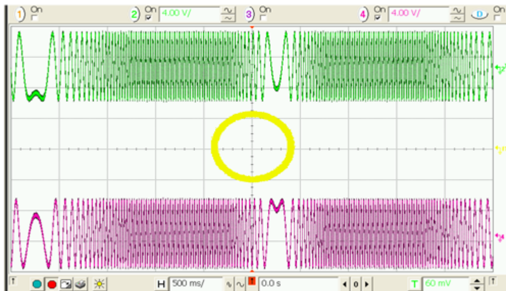
FIGURE IV.32: Résultats expérimentaux (Estimateur EstMP - DTC classique) avec application de charge : Flux \phi_\alpha et \phi_\beta (1 wb/div)
