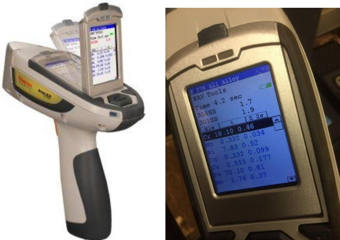
Fig. 17 : Photo de portatif XL3t XRF de marque Thermo Scientific NITON
