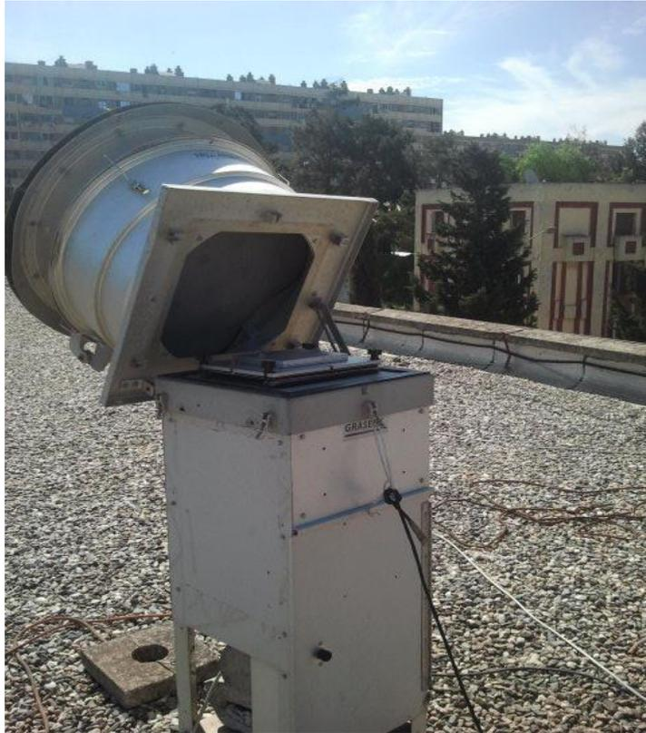
*Fig. 14 : Photo de l'échantillonneur HVS installé au niveau de la mairie d'El-Mohammadia, Alger.*
