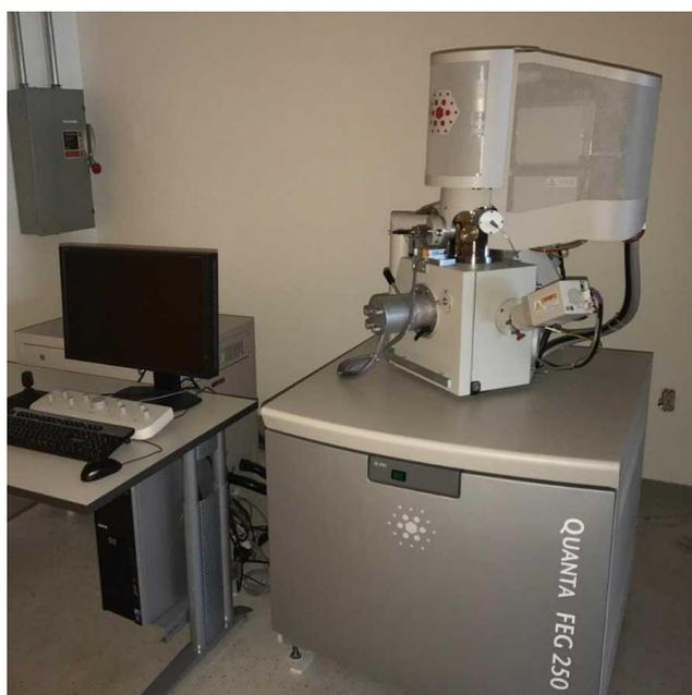
*Fig. 16 : Photo de l'appareil de microscopie électronique à balayage (MEB- Quanta 250, Société FEI) couplée à la spectroscopie à rayons X*
