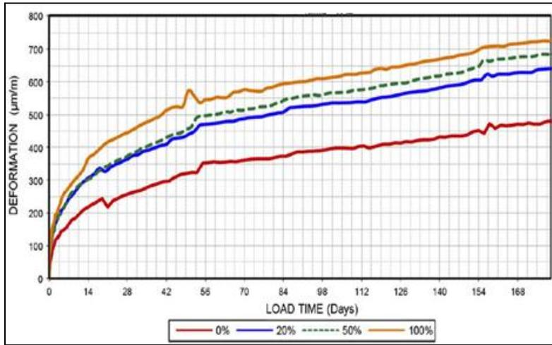
Figure 1.30. Déformation totale due à l'effet de fluage [Domingo et al. 2010].
