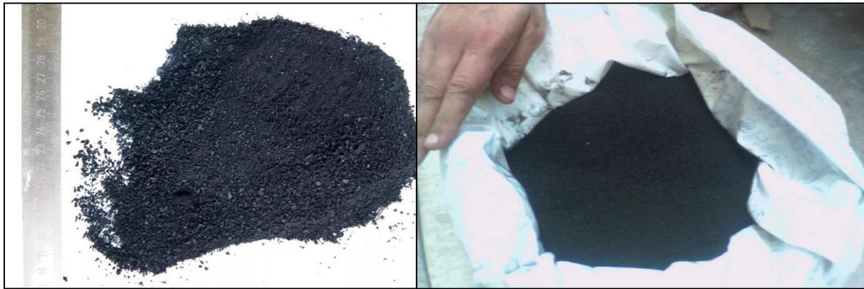
Figure.4.1 Particules en caoutchouc utilisées dans le programme expérimental.
