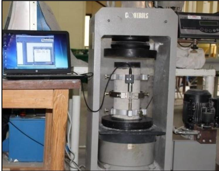
Figure 4. 11 Dispositif de mesure du module d'élasticité.
