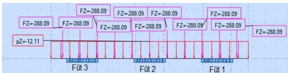
Figure 11. 11: Schéma de répartition des charges sur le chevêtre
