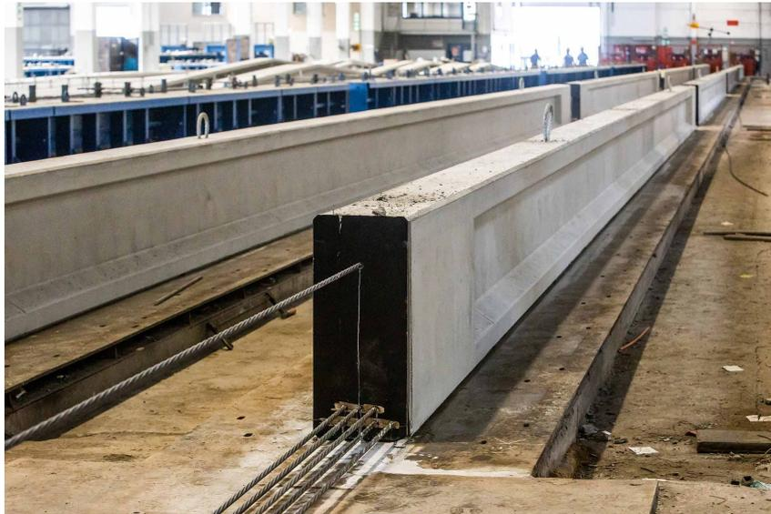
Figure 1.8 – Poutre préfabriquée en béton précontraint
