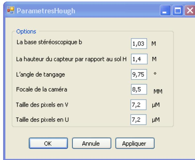
Figure 6.26 La fenêtre Paramètres du capteur stéréoscopique
