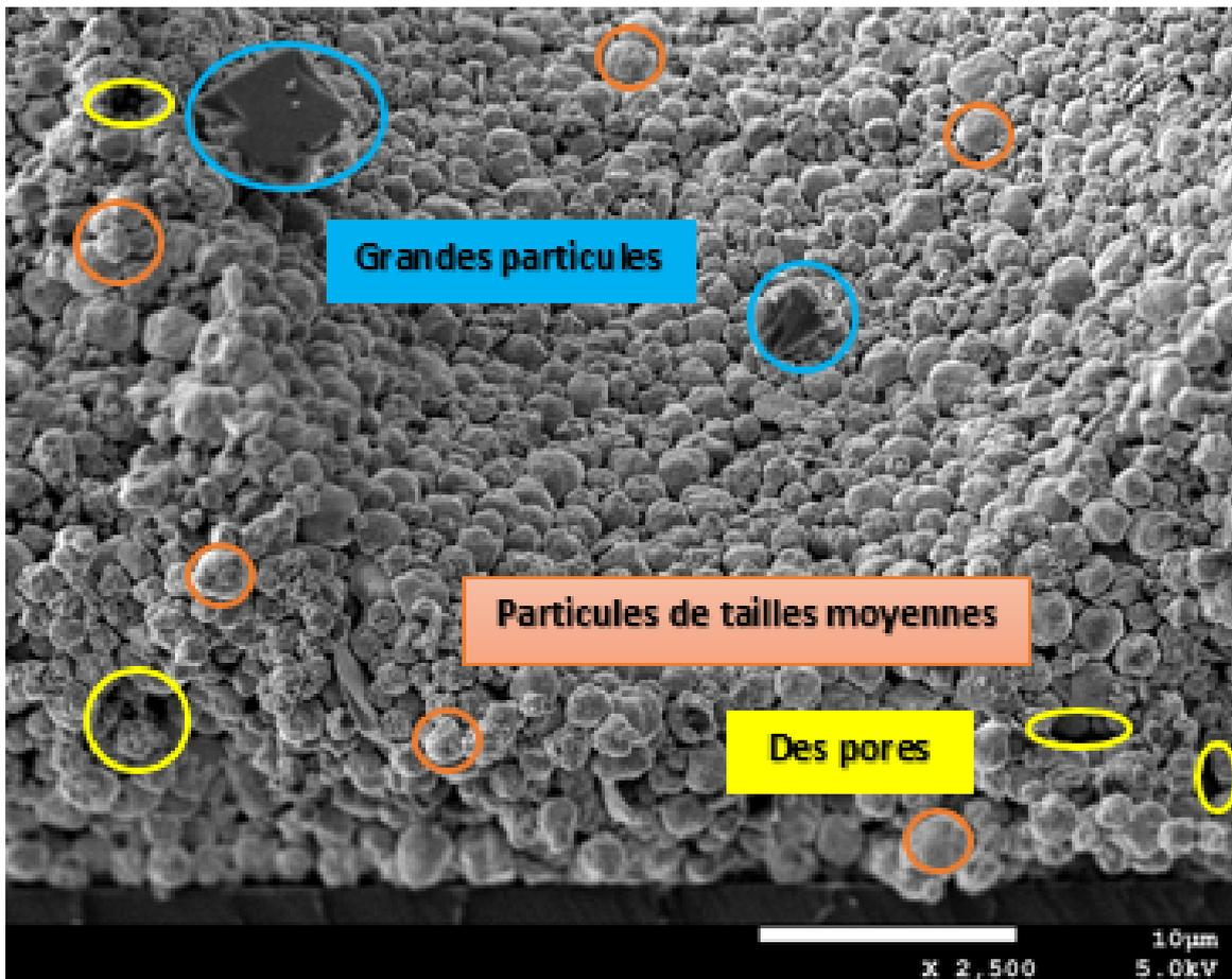
Fig. 5.17 : Une image par MEB de l'échantillon métallisé par une pâte d'Ag  $1.34\%\text{Al}$  avant cuisson.
