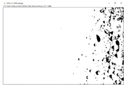
(b) Image de la distribution des pores de l'échantillon  $I_2$  par imageJ .
