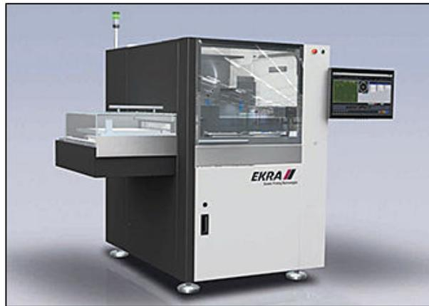
Fig. 4.4 : Machine de sérigraphie utilisée dans cette étude : EKRA Screen printing technologies [74].
