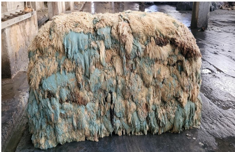
Figure 10: Epilage-pellantage de la peau avec ajout de chaux hydraté Ca(OH)_2 et sulfure de Sodium Na_2S .
