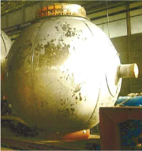
Figure 21: Sphère d'hydrolyse (réacteur).
