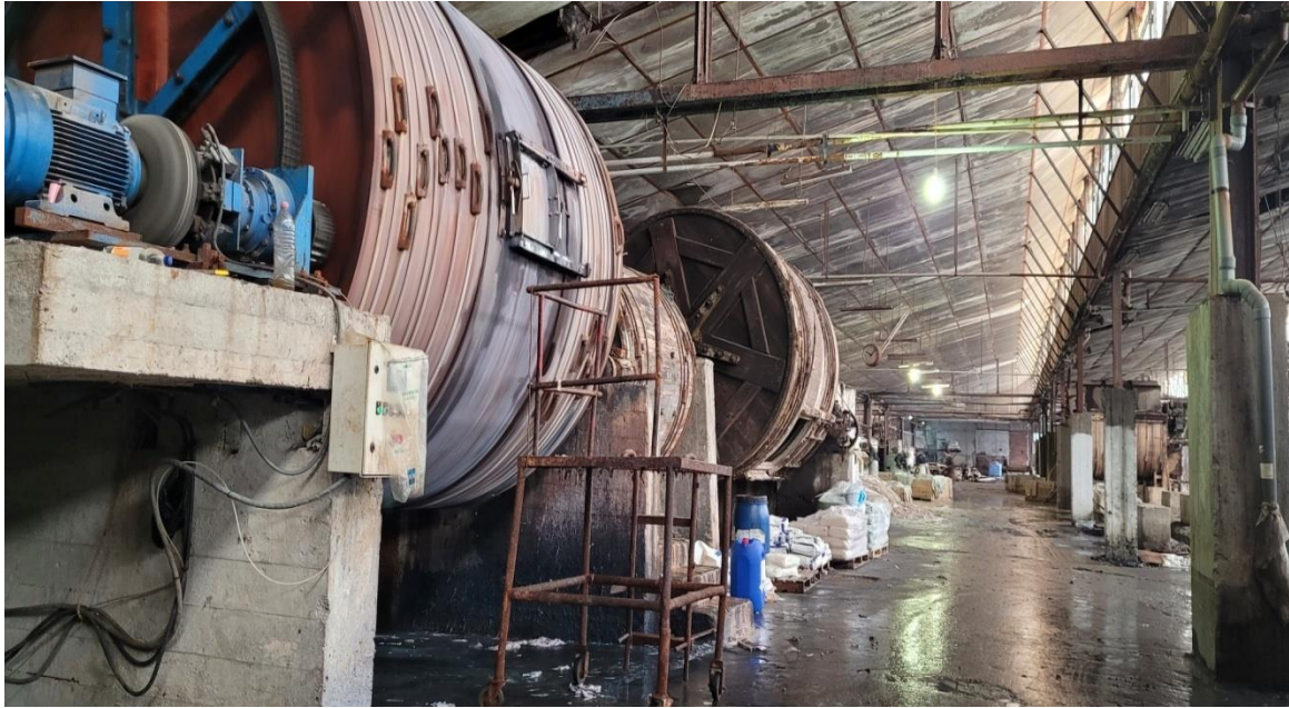
Figure 13:Foulon utilisé pour le tannage du cuir.
