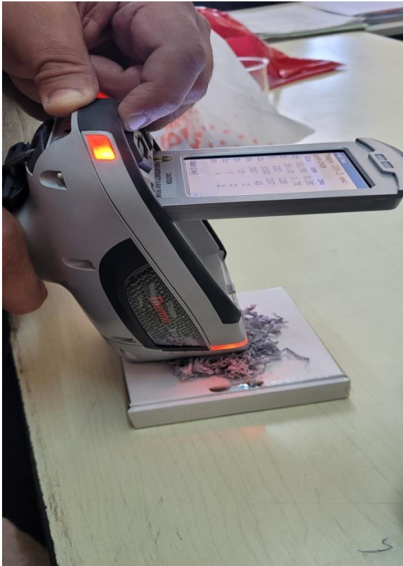
Figure 32: Spectromètre de fluorescence X portatif Thermo Scientific Niton™ XL3t XRF.
