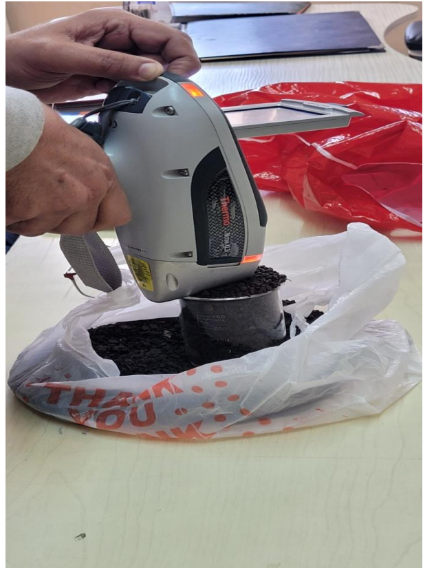
Figure 32: Spectromètre de fluorescence X portatif Thermo Scientific Niton™ XL3t XRF.
