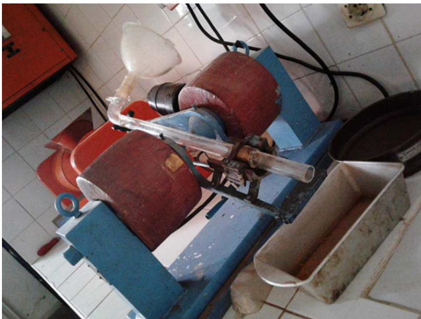
Figure 48 : Le tube magnétique de Davis utilisé pour le processus de concentration
