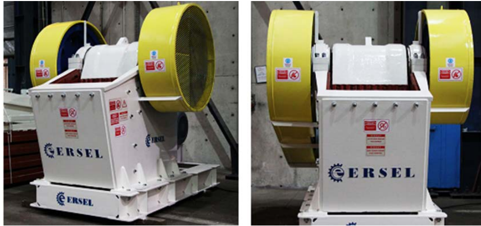
Figure 44 : Le concasseur à mâchoires utilisé pour le concassage du charbon
