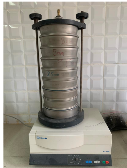
FIG. 2.10 : Analyse granulométrique des calcaires.
