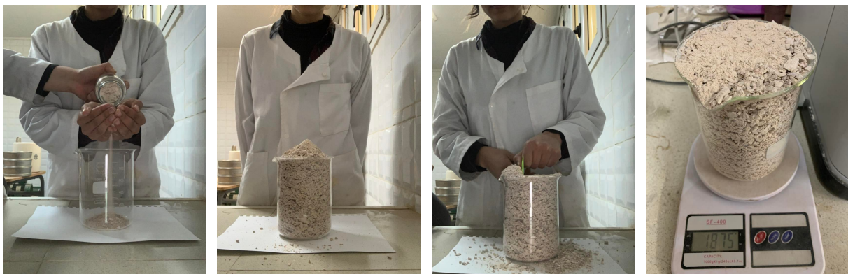
FIG. 2.7 : Détermination de la densité apparente des calcaires.
