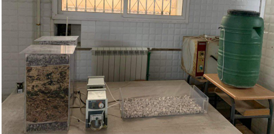
FIG. 2.28 : Photo réelle représentant la configuration du modèle physique du traitement de DMA fortement contaminé à l'échelle intermédiaire.
