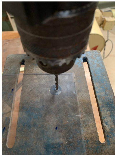
FIG. 2.27 : Perforation du plexiglas à l'aide d'une perceuse à colonne.
