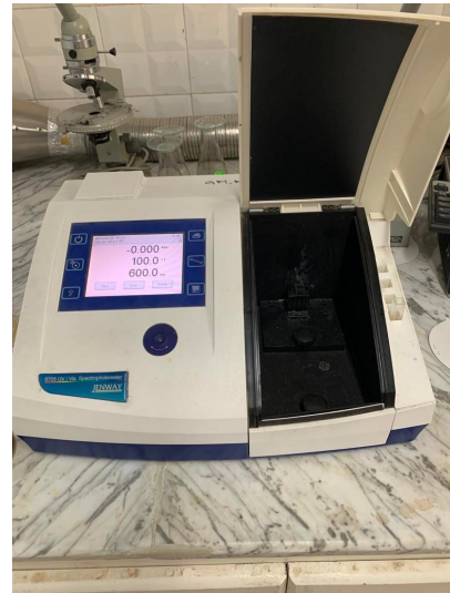
FIG. 2.31 : Détermination de l'absorbance et la transmittance avec un spectromètre UV-Visible.
