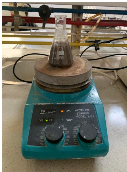
FIG. 2.12 : Détermination du potentiel de neutralisation.
