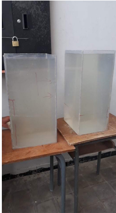
FIG. 2.23 : Vérification de l'étanchéité des compartiments.
