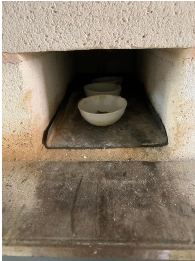
FIG. 2.9 : Détermination de la teneur en eau des calcaires.
