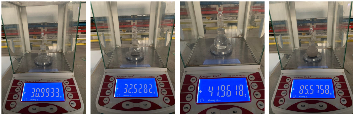
FIG. 2.8 : Détermination de la densité absolue des calcaires.
