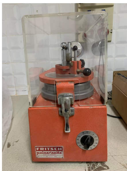
FIG. 2.3 : Un broyeur mortier de type FRITSCH .
