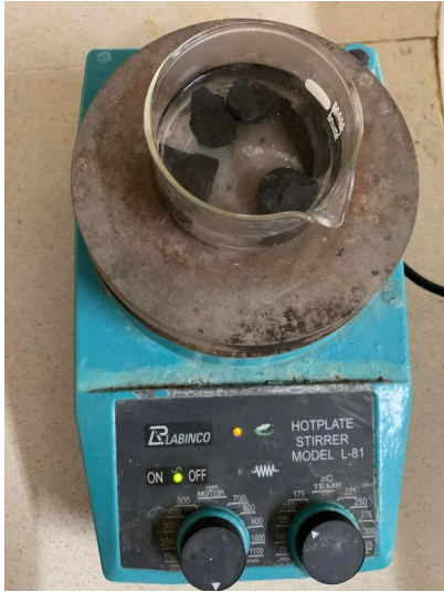
FIG. 2.6 : Détermination de la porosité des calcaires.
