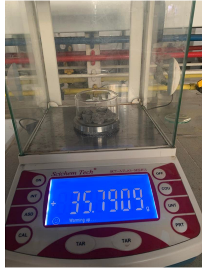
FIG. 2.6 : Détermination de la porosité des calcaires.
