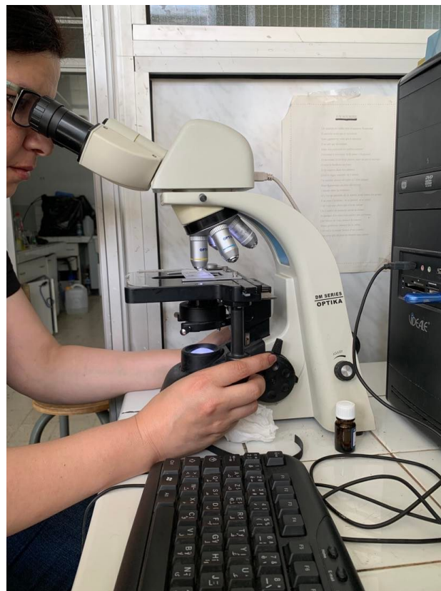
FIG. 2.32 : Dénombrement en moyennant une cellule Malassez et un microscope optique.
