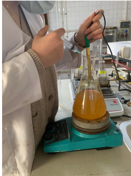
FIG. 2.29 : Contrôle du pH du DMA synthétique.
