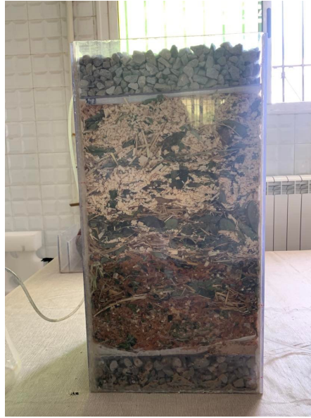
FIG. 2.24 : Détermination du volumes des vides des BPSR.
