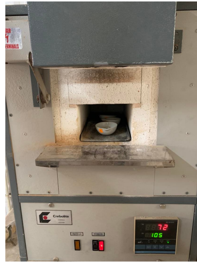
FIG. 2.9 : Détermination de la teneur en eau des calcaires.
