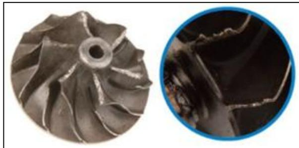
*Figure 2.7: Dommages causés à l'inducteur de la turbine.*
