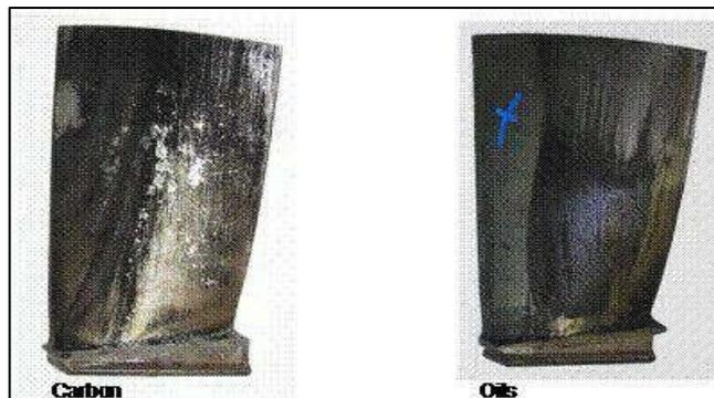
*Figure 2.9: Encrassement d'une aube de compresseur.*
