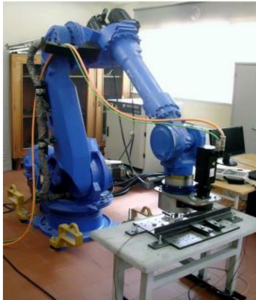
Figure 1-14 Robot poly-articulé pour FSW de l'université de Coimbra [17]
