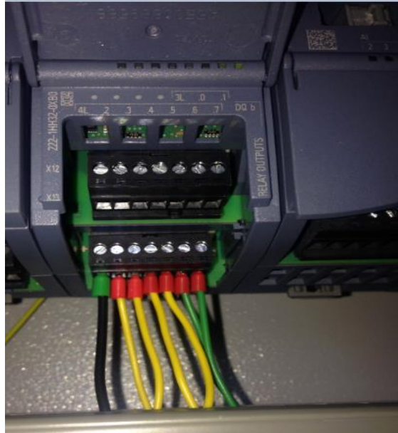
Figure 3.29. Câblage des sorties
