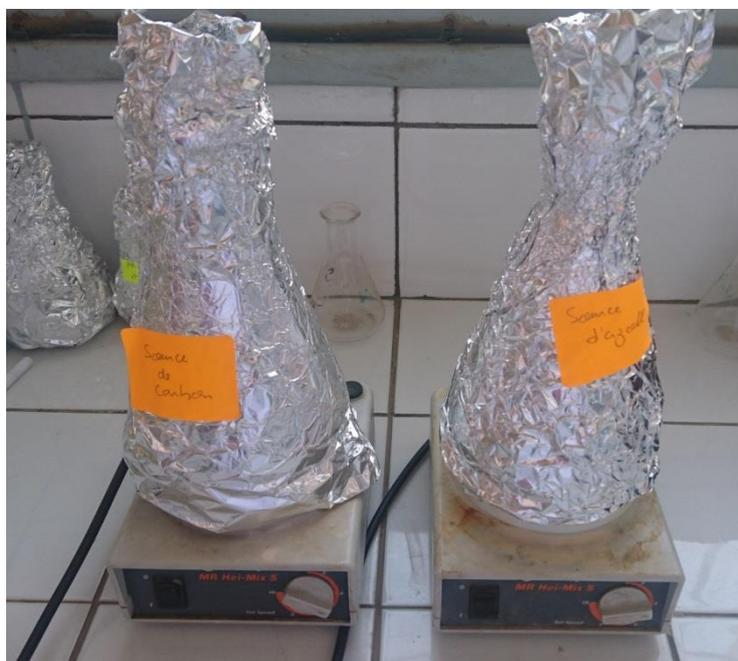
**Figure 27 : sélection des souches microbiennes utilisant la cyperméthrine comme unique source de carbone ou comme unique source d'azote.**
