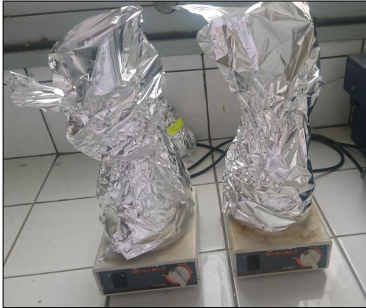
**Figure 26: Acclimatation des boues activées au pesticide.**
