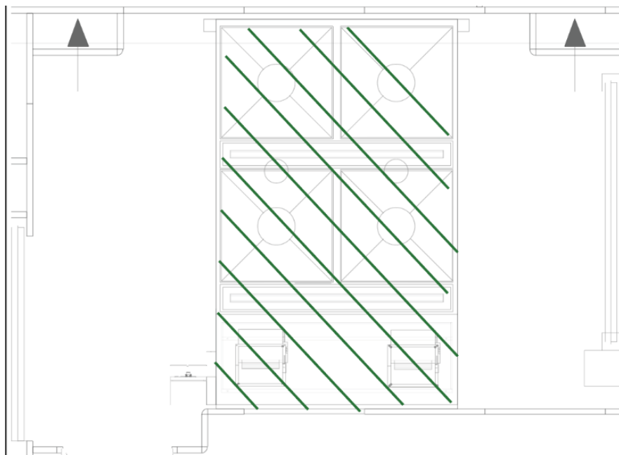
FIGURE 4.8 – Classification en zone : Local de pesé liquide
