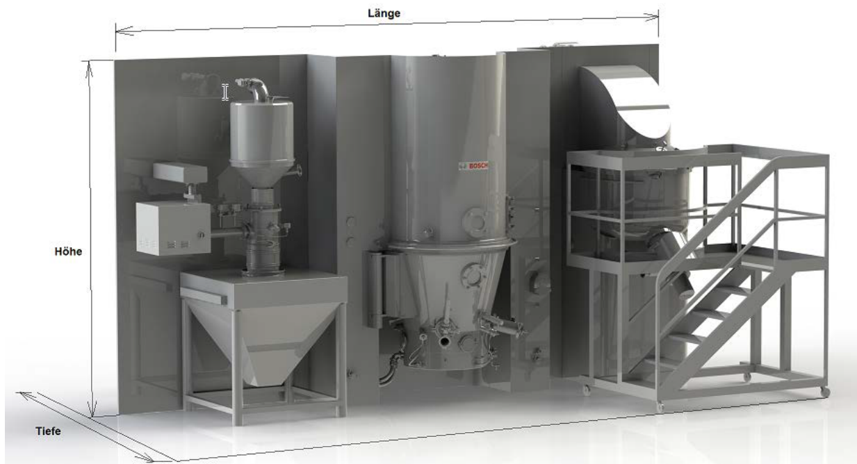
FIGURE 4.15 – Schéma du procédé de granulation séchage calibrage
