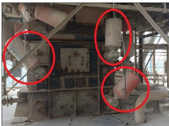
Figure 3.15 : Disposition des air-chocs au niveau du calcinateur [26]
