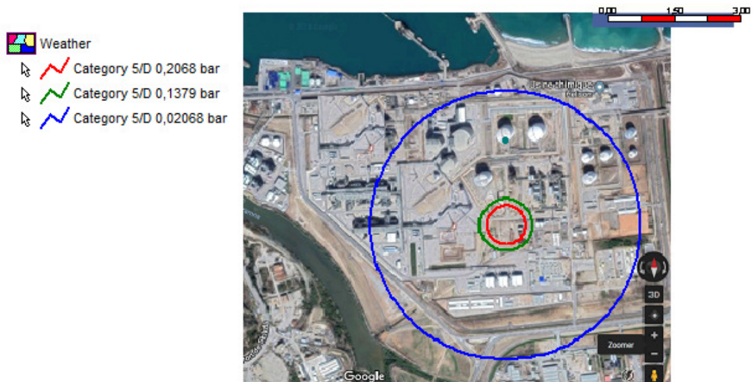
Figure V.12 : Image de variation des effets de surpression de l'UVCE.
