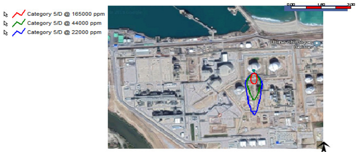
Figure V.4 : Image de variation des concentrations du gaz dispersé.
