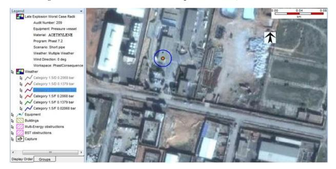
Figure 4.23. Présentation des rayons de surpressions critiques sur la carte géographique Tableau 4.18. Surpression en fonction de la distance
